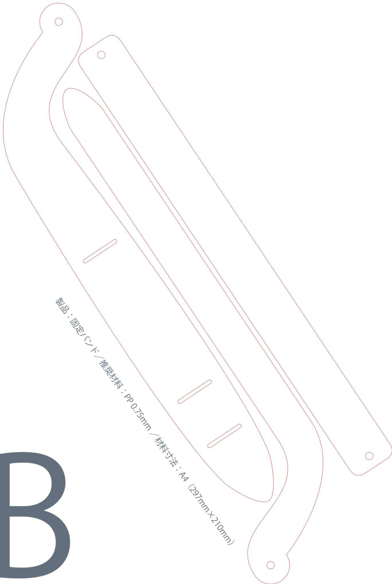
製品：固定バンド／推奨材料：PP 0.75mm／材料寸法：A4 (297mm×210mm)
