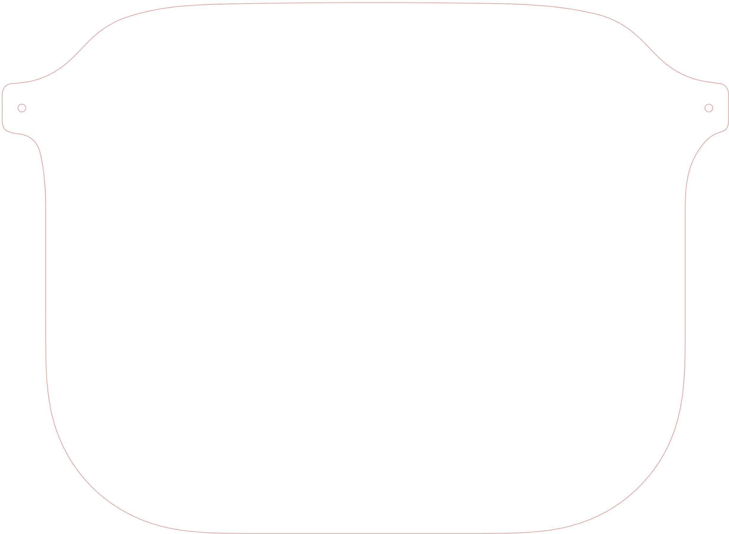
製品：フェイスシールド／推奨材料：PET 0.5mm／想定材料寸法：A3（420mm×297mm）
